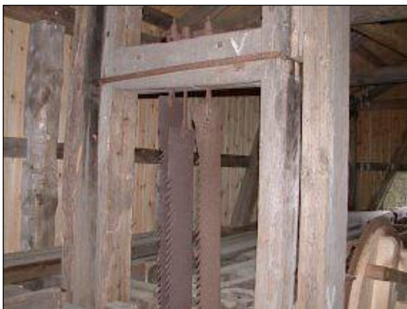
En silkesag er en type oppgangssag med tre sagblad som kunne skjære tømmerstokken i tre planker samtidig.
