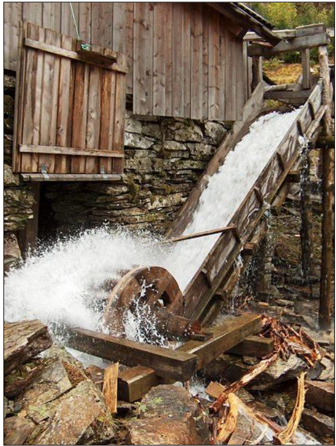
Eksempel på en oppgangssag med et underfallshjul. Foto: Svein Harkestad Vannet ledes fra toppen via en renne ned mot vannhjulet som drives rundt.
