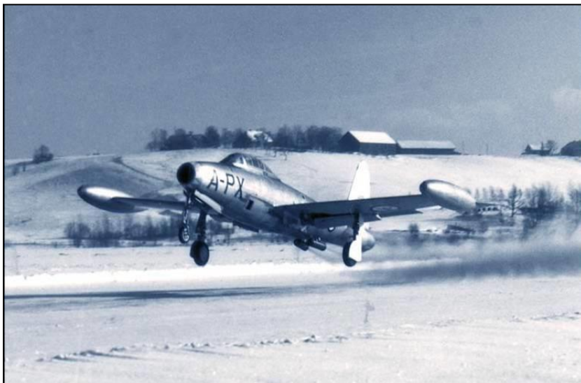
F-84 tar av med hjelp av JATO (Jet Assisted Take Off) Foto: Forsvarsmateriell, Kjeller
