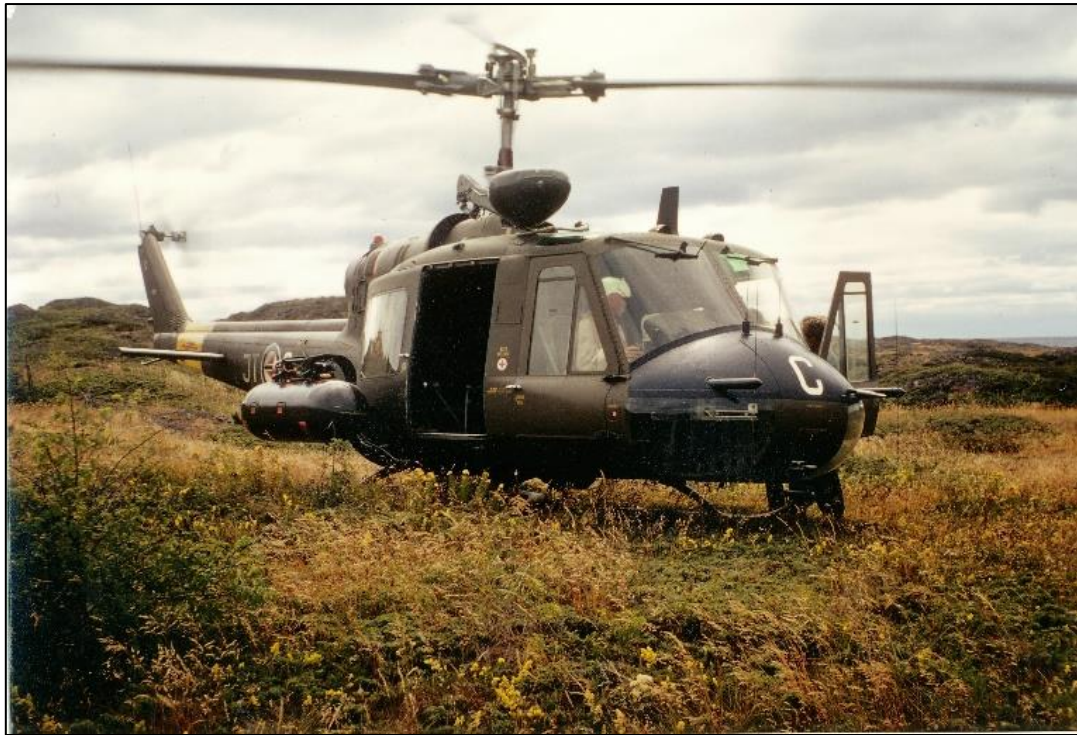
Bell UH-1B med ekstra utvendige drivstofftanker og redningsheis. Foto: Roar Glenne
